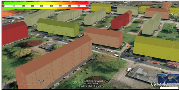
Abbildung 3: Beispiel für die Darstellung des Jahres-Primärenergiebedarfs verschiedener Gebäude eines Wohnviertels innerhalb des Gebäudeinformationssystems
