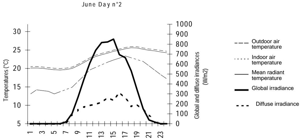
Fig. 5 : Evolution of thermal parameters versus time
